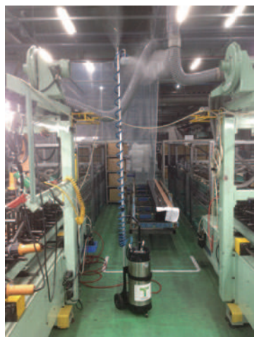
水溶性タイプの消臭剤「デオファインT・WS」のデモンストラーション。噴霧装置は機械系の技術も駆使して開発した
